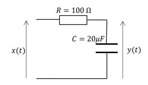
On désire réaliser un équivalent numérique de ce filtre. Le signal x(t) est échantillonné avec une fréquence d'échantillonnage  $f_e=1\ 000Hz$  pour constituer une suite  $x_n$ . En sortie de filtre, on retrouve une suite  $y_n$ .
